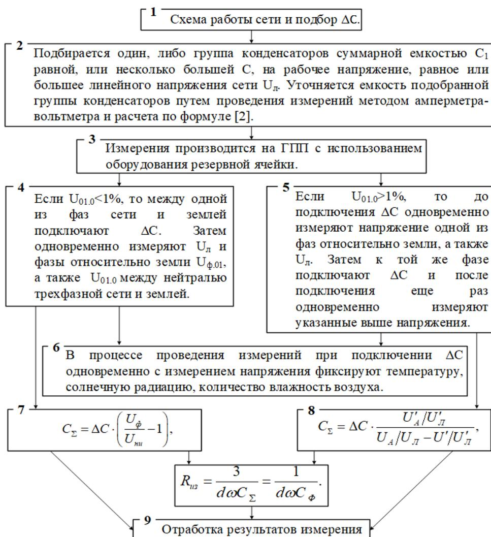
Рисунок 2 – Методика измерений в реальных РЭС напряжением 6-35 кВ
