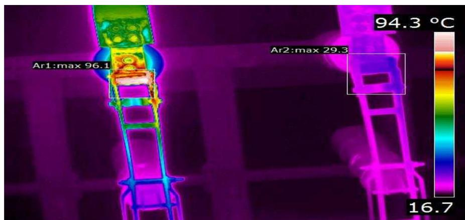
Рисунок 3 - Дефект контактного соединения опорного изолятора шинного разъединителя напряжением 35 кВ
