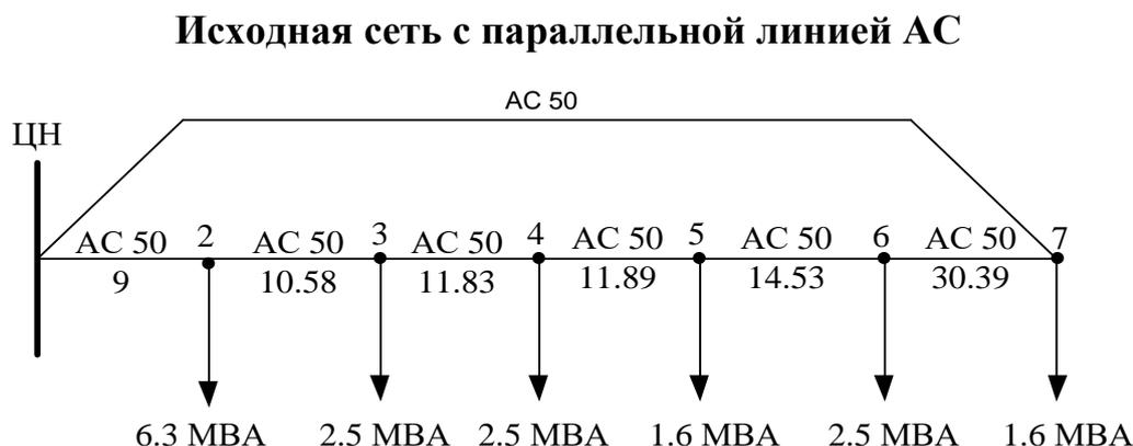
Рисунок 2. – Принципиальная схема участка сети 35 кВ с параллельной линией АС
