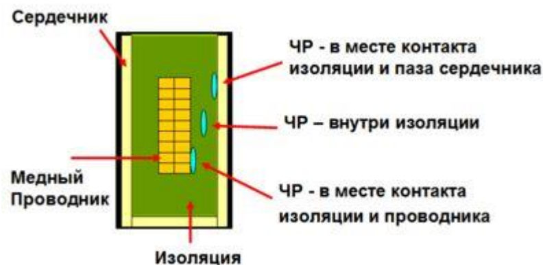
Рисунок 2. Появление частичных разрядов в различных частях обмотки
