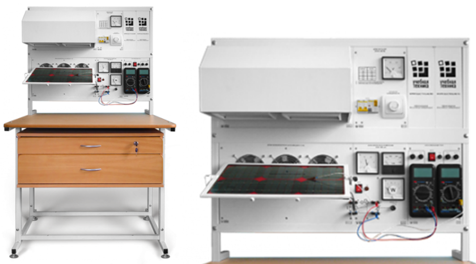
Расми 3.3. Намуди умумии амудмизи озмоишӣ: 1–модули офтобӣ; 2–манбаи равшанӣ; 3–блоки идора ва назорат.
