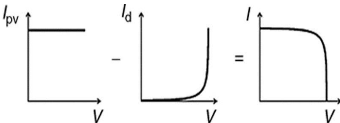
Рисунок 2.5. Происхождение кривой I – V солнечной панели
