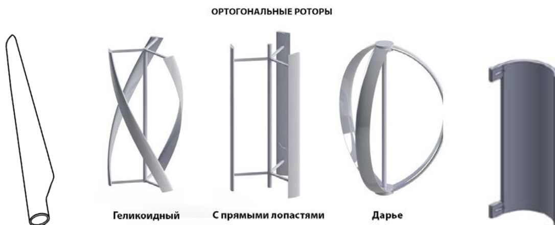
Расми 8 - Намудҳои парраҳои ДББ: а) болмонанд (крылчатые); б) росткунча (рост); в) кач (моҳмонанд); г) геликоиди; д) нимсилиндри.
